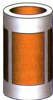
Рис. 5. Трубчатый пьезосканер.
