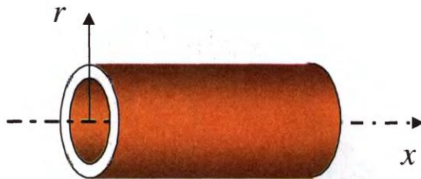
Рис. 3. Трубчатый пьезоэлемент.
